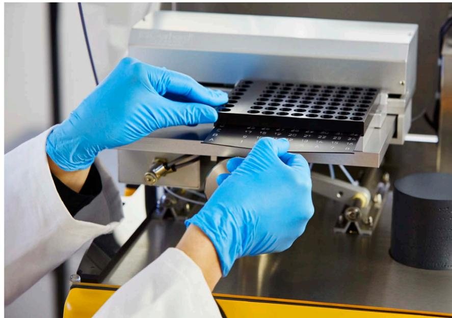
Exakte Position – exakte Rückverfolgung: Die Proben haben vordefinierte Positionen.
