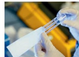
Aufschluss und Filtration erfolgen beim FibreBag-Verfahren in einem großzügig bemessenen Filterbeutel aus hochpräzisiertem Spezialgewebe, welches die Filtrationsbedingungen wiederholbar standardisiert. Die FibreBags werden am Ende eines jeden Aufschlussprozesses zusammen mit dem Probenrest verascht. Durch den Einmalgebrauch erfolgt jede Analyse unter stets gleichen, standardisierten Filtrationsbedingungen und erzeugt so exakt reproduzierbare Ergebnisse.
