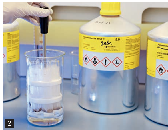
2 Komfortable, zeitsparende Entfettung mit Lösemittel im Entfettungsmodul. 6 Proben können gleichzeitig entfettet werden.
