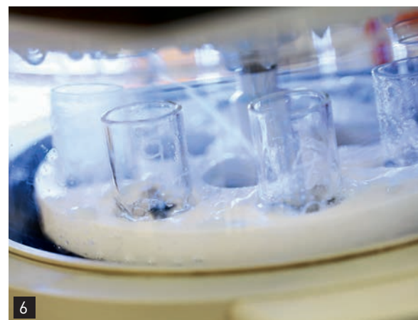
6 Die Drehung des Probenkarussells sorgt für eine optimale Durchflutung der Probe. Die Rotation wird durch den Detergenzienstrahl erzeugt.
