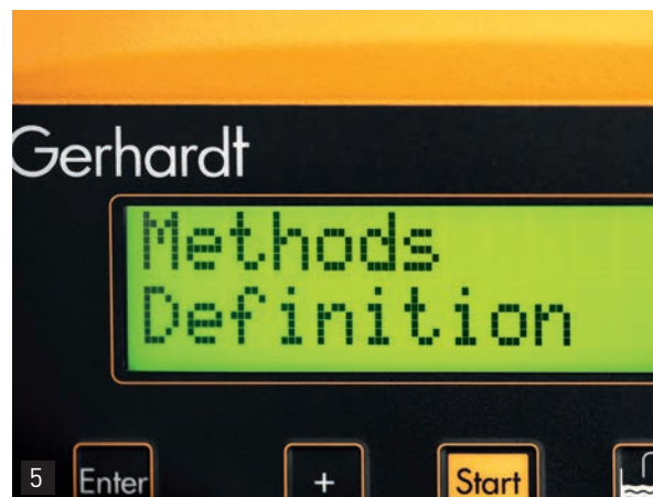
5 9 verschiedene Methoden können frei konfiguriert und gespeichert werden.
