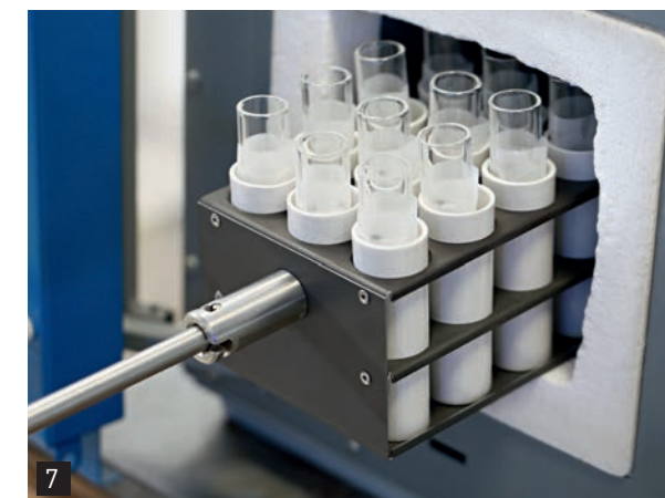
7 Das Veraschungsmodul mit langem Griff erleichtert die Handhabung der Proben.
