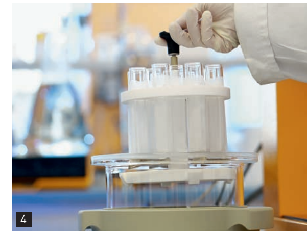
4 Der abnehmbare Handgriff erleichtert Einsatz und Entnahme des Probenkarussells.
