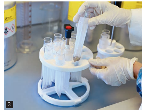
3 Beim Einsetzen der FibreBags in das Probenkarussell werden diese automatisch rutschfest verklemt.
