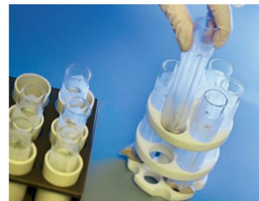
„Für die manuelle Analyse stehen platzsparende Systeme mit 1 oder 6 Heizstellen zur Bearbeitung von bis zu 36 Proben zur Verfügung.“
