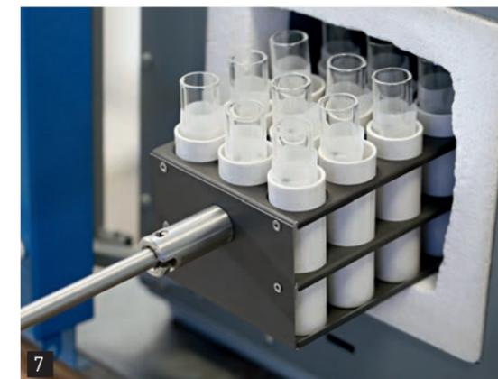
Con su larga empuñadura, el módulo de incineración facilita la manipulación de las muestras.
