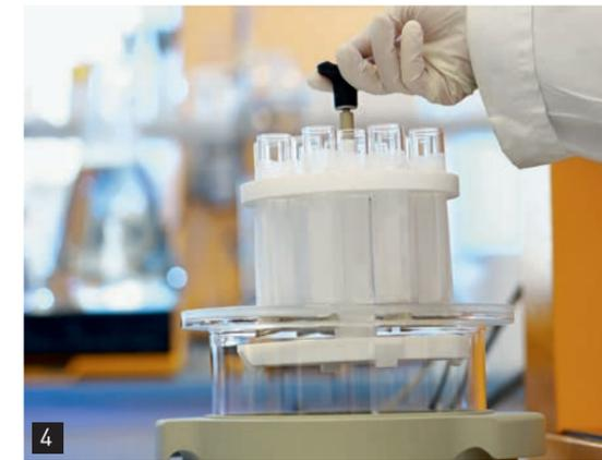
El tirador desmontable facilita el uso y la extracción del carrusel de muestras.
