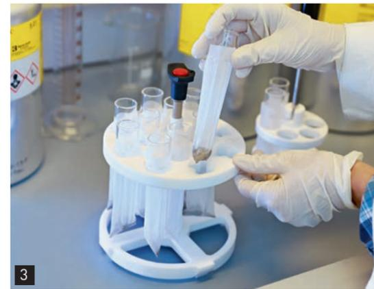
Al insertar las bolsas FibreBag en el carrusel de muestras quedan fijadas automáticamente y no pueden desplazarse.
