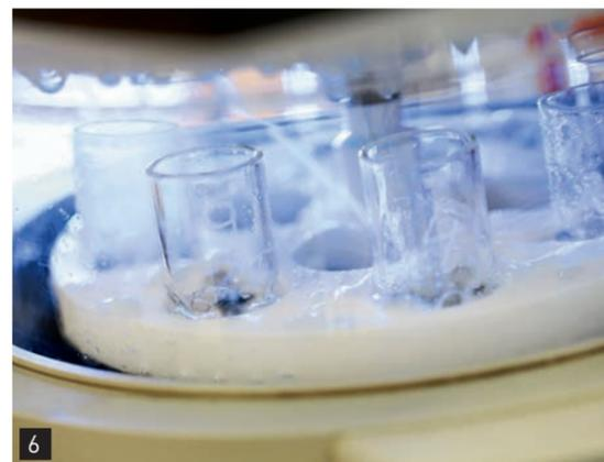
La rotación del carrusel permite bañar la muestra de forma óptima. La rotación es generada por el detergente a presión.
