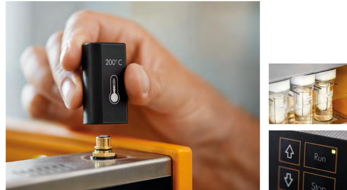
+ Separat aufsteckbare **Grenztemperaturstecker** für 135°C, 200°C und 300°C sowie die **programmierte Höchsttemperatur** sorgen für doppelte Sicherheit. Bei Überschreiten der Grenztemperatur wird die Extraktion automatisch unterbrochen.
