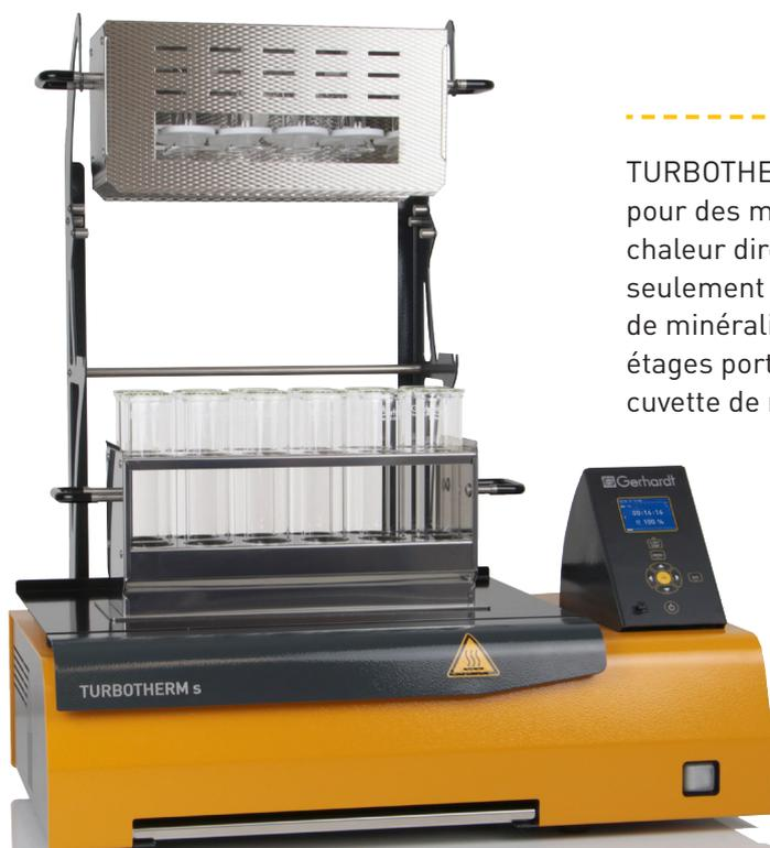
TURBOTHERM est une unité de minéralisation rapide, à infrarouge, pour des minéralisations sans retard à l'ébullition. L'apport de chaleur direct permet de porter 12 échantillons à ébullition en seulement 10 minutes. TURBOTHERM est très variable : des tubes de minéralisation de 100 à 800 ml sont possibles. La console à étages porte le portoir de tubes, le dispositif d'aspiration et la cuvette de récupération et permet un travail confortable.
