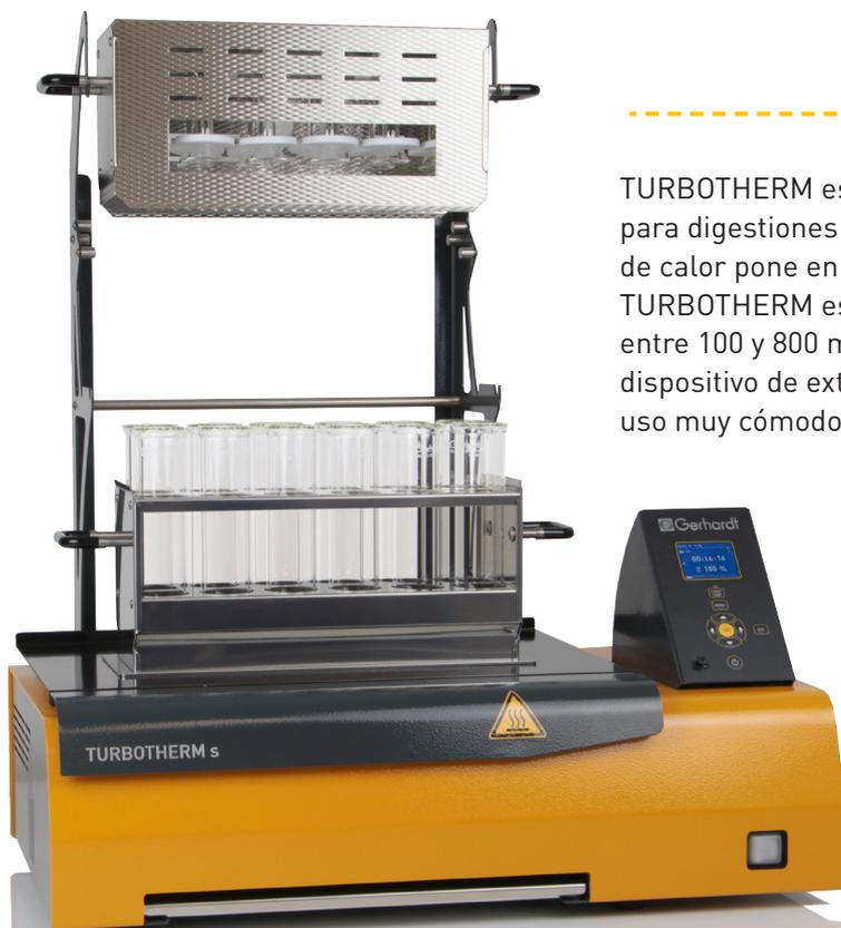
TURBOTHERM es un sistema de digestión rápida por infrarrojos para digestiones sin retardo de ebullición. La generación directa de calor pone en ebullición 12 muestras en tan solo 10 minutos. TURBOTHERM es muy variable: Son posibles tubos de digestión de entre 100 y 800 ml. En la consola multinivel se alojan la gradilla, el dispositivo de extracción y la bandeja de goteo, lo que permite un uso muy cómodo.
