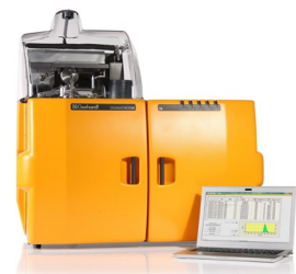
Abb. 3: Dumas-Analysensystem DUMATHERM von C. Gerhardt 2021
