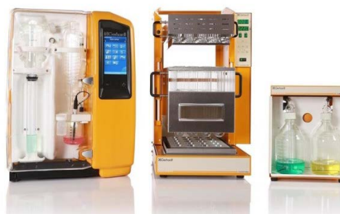
Fig. 9 : système complet pour l'analyse de l'azote selon Kjeldahl, constitué d'un système de minéralisation 20 emplacements KB20 (milieu) avec épurateur de gaz TURBOSOG (à droite) et unité de distillation à la vapeur d'eau VAPODEST 50s avec titrage implémenté (à gauche).
