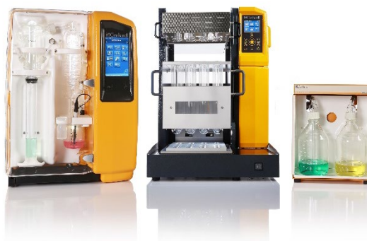
Fig. 9 : système complet pour l'analyse de l'azote selon Kjeldahl, constitué d'un système de minéralisation 20 emplacements KT-L20 (milieu) avec épurateur de gaz TURBOSOG (à droite) et unité de distillation à la vapeur d'eau VAPODEST 500 avec titrage implémenté (à gauche).
