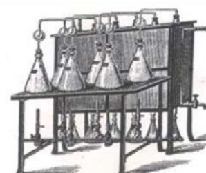
Fig. 3 : Appareil à brûleurs à gaz pour la distillation de solutions de minéralisation
