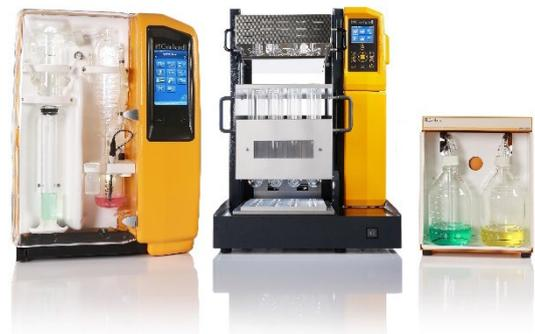
Abb. 9: Komplettsystem zur Stickstoffanalyse nach Kjeldahl, bestehend aus 20fachem Aufschlusssystem KT-L20 (Mitte) mit Gaswäscher TURBOSOG (rechts) und Wasserdampfdestillations-einheit VAPODEST 500 mit implementierter Titration (links).
