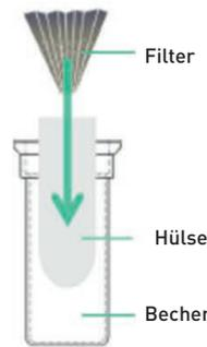
3. Filter in Extraktionsbecher einsetzen
